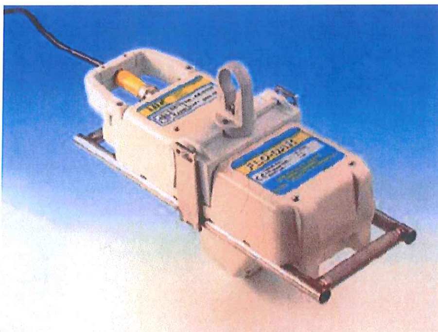
Figura 6 – Sonda misuratrice del tirante idrico e della velocità di flusso
