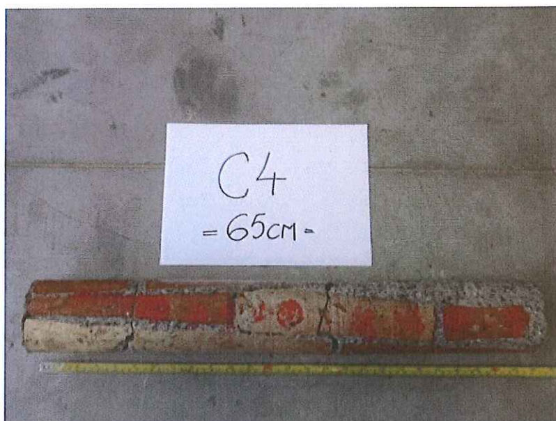
CAROTA 4: lunghezza 65 cm – profondità terreno naturale non raggiunta
