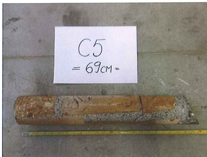
CAROTA 5: lunghezza 69 cm – ha raggiunto la profondità del terreno naturale
