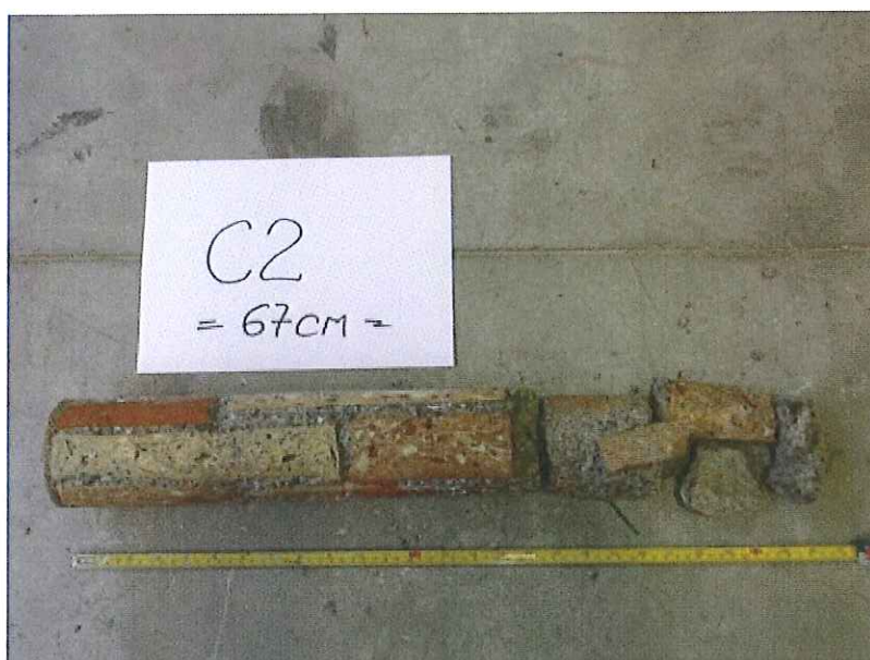
CAROTA 2: lunghezza 67 cm – ha raggiunto la profondità del terreno naturale
