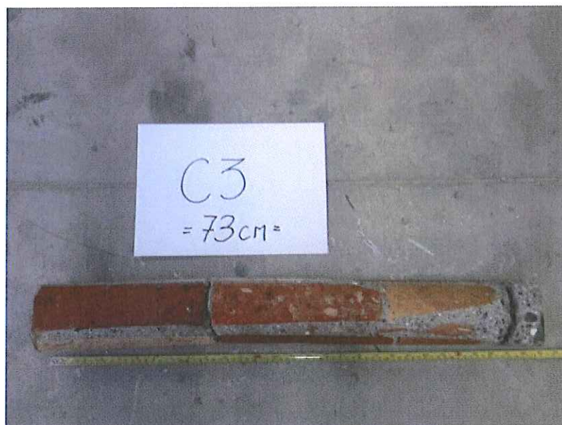
CAROTA 3: lunghezza 73 cm – profondità terreno naturale non raggiunta
