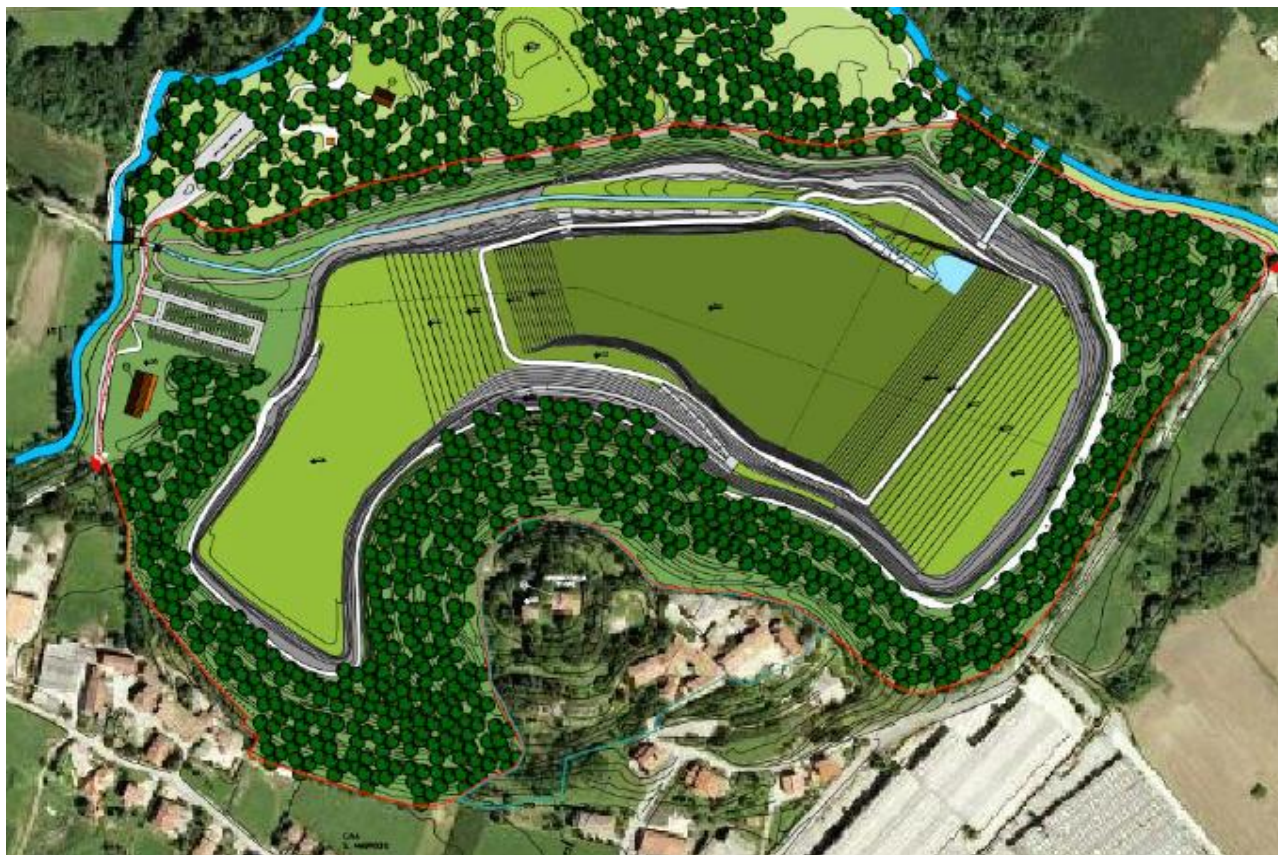
Alternativa con impermeabilizzazione delle pareti e parziale riempimento della ex-miniera (fonte: Parco della Valle del Lambro)
