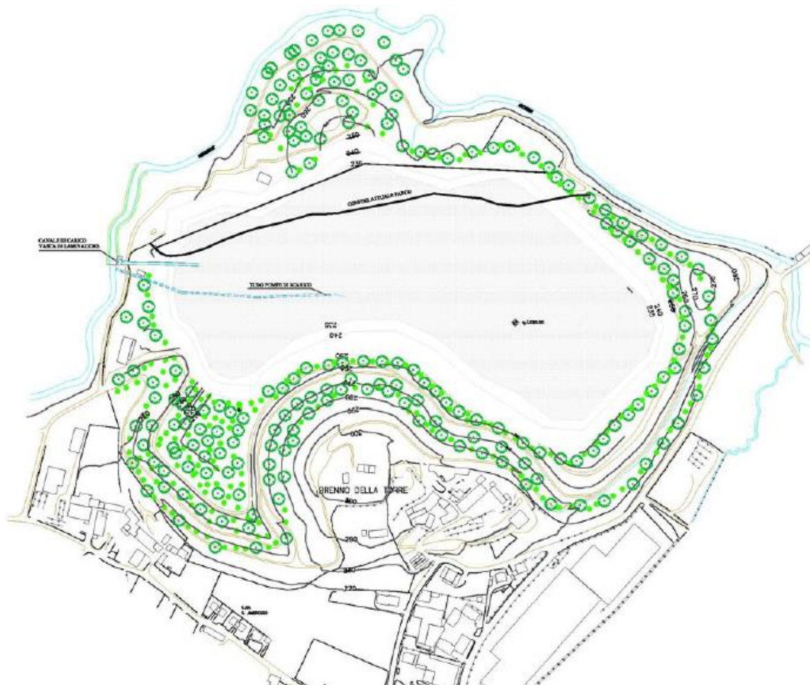
Alternativa con riempimento progressivo della ex-miniera sino a raggiungere quota 230 m slm (fonte: Parco della Valle del Lambro)
