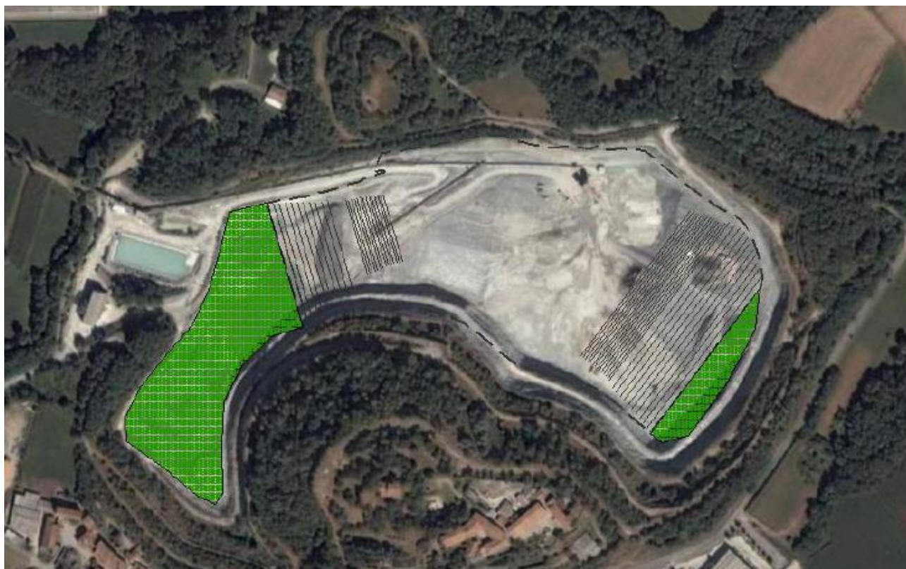
Le aree di riempimento previste a quota 236 m slm nel progetto di recupero (fonte: Parco della Valle del Lambro)
