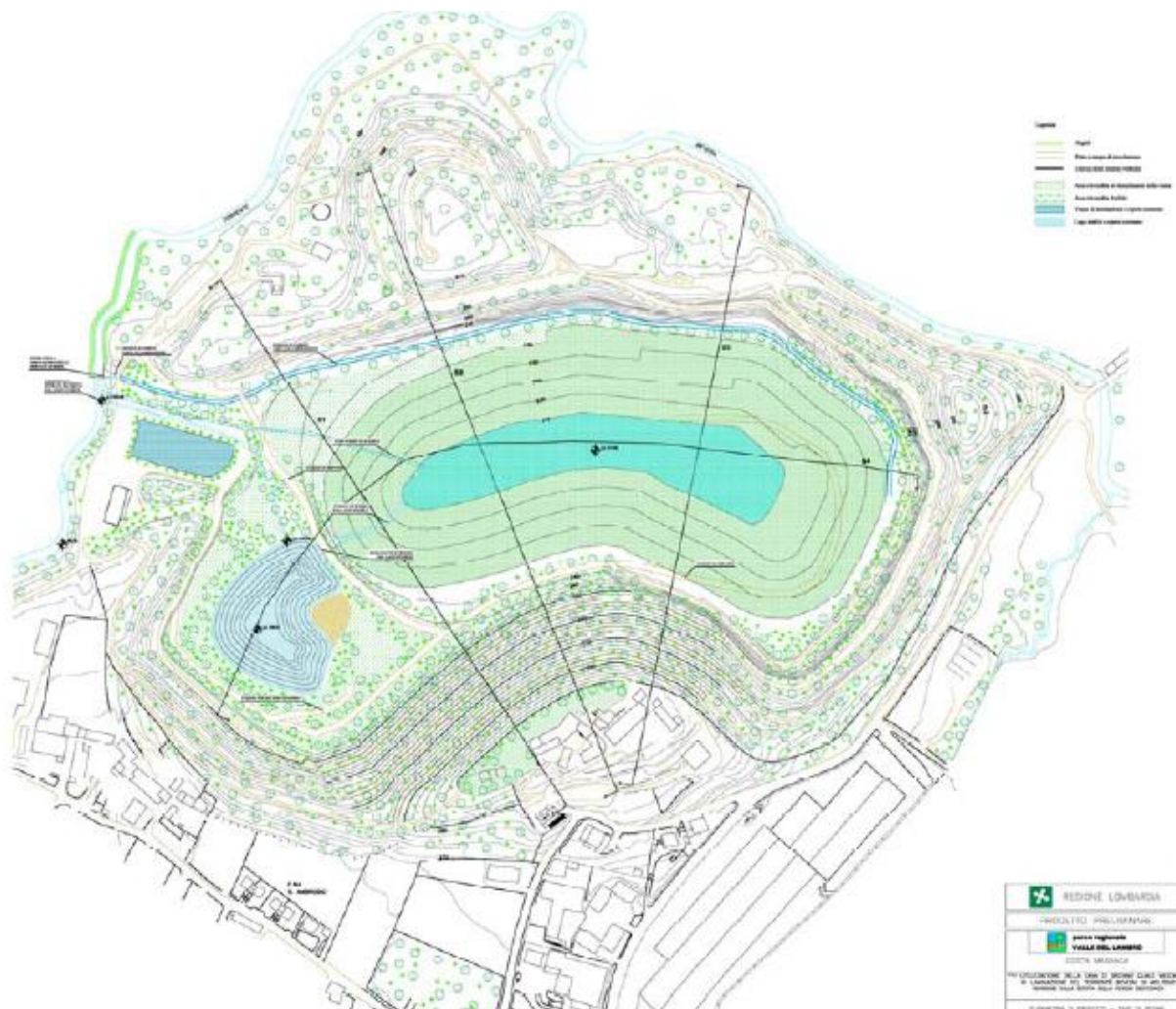
Alternativa con riprofilatura della parete sud e parziale riempimento della ex-miniera (fonte: Parco della Valle del Lambro)
