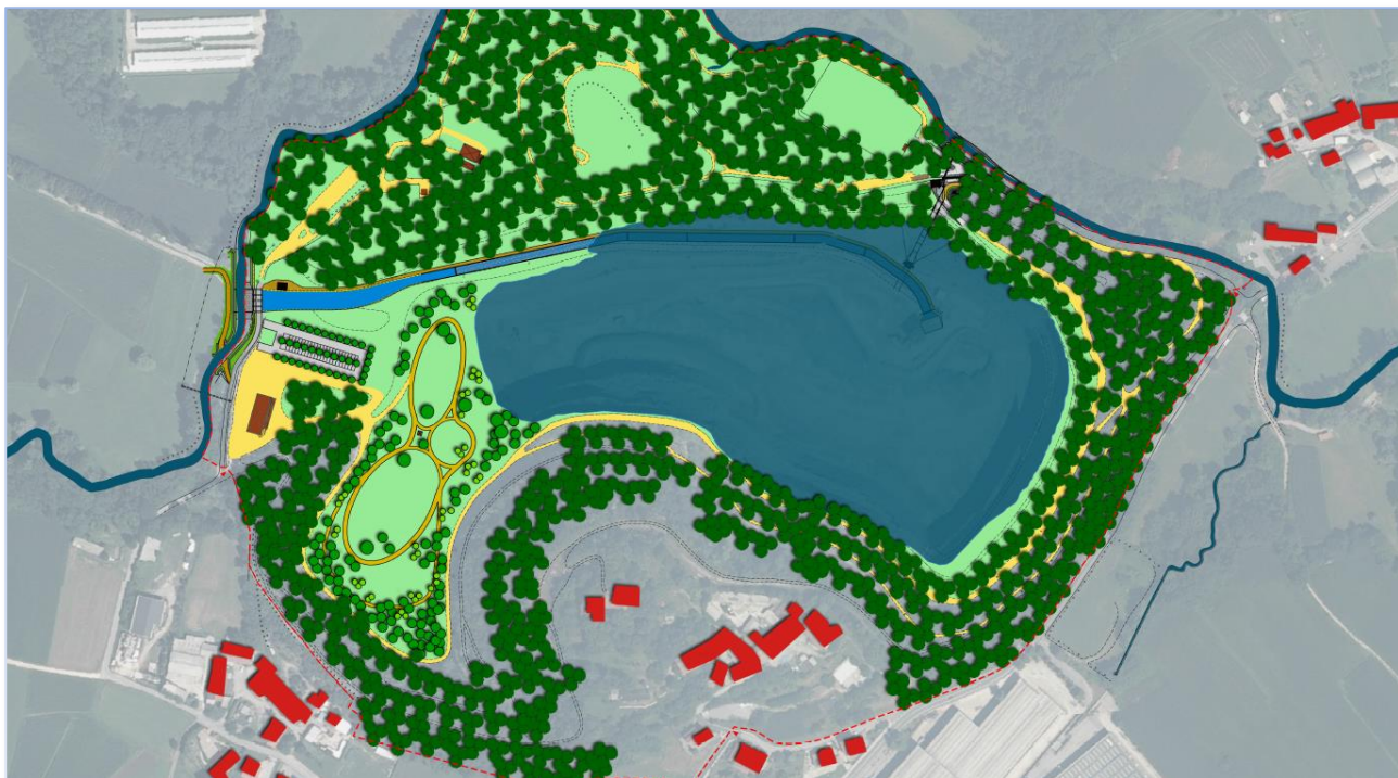
Restituzione grafica dell'area dell'ex-Miniera di Brenno con il livello massimo previsto per il bacino di laminazione.
