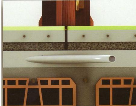
Figura 11: esempio di interruzione dei massetti
