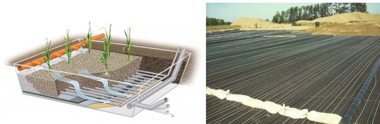
Figura 19: AEW, sistemi di fitodepurazione aerati (fonte: GWT)
