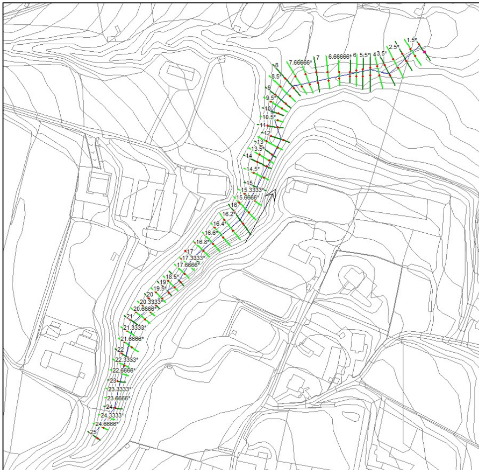
Figura 10 – Geometria di modellazione per lo stato di fatto della roggia a Sud
