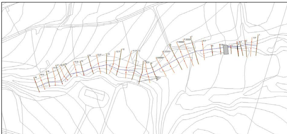
Figura 9 – Geometria per la simulazione dello stato di fatto della roggia a Nord
