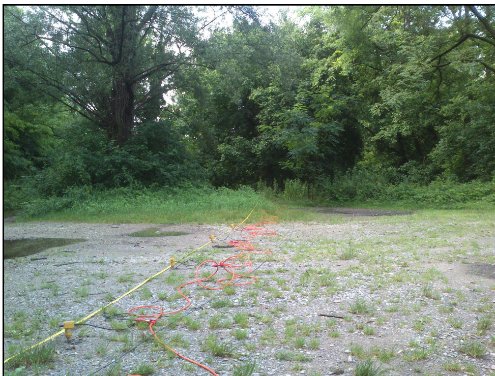
Figura 12: Stendimento dei 24 geofoni per indagine MASW.
