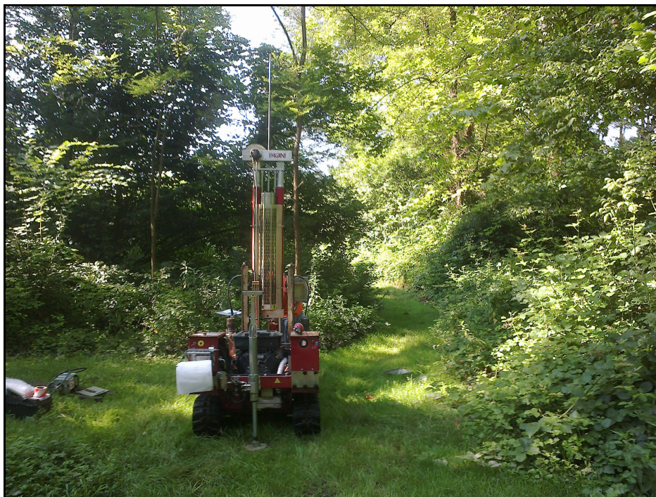
Figura 8: Esecuzione prova penetrometrica P1.
