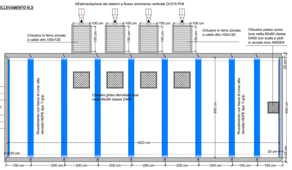
**SCATOLARI GIUNTO SALDATO 600 x 275 L. 200 spess. 25 cm.**
