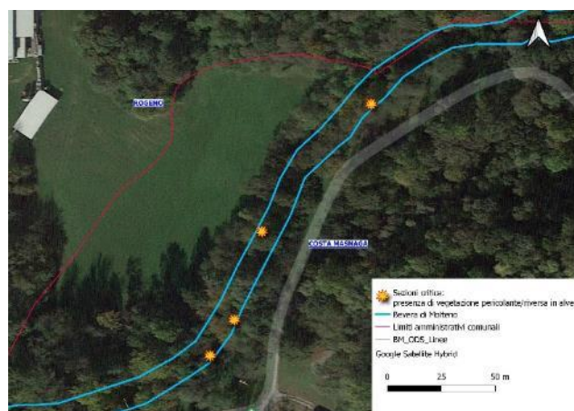
Figura 1-6 Criticità B3: Alcune problematiche riscontrate durante il sopralluogo (tratto fluviale mostrato nel riquadro in basso a destra) legate principalmente alla presenza di piante pericolanti o riverse in alveo.
