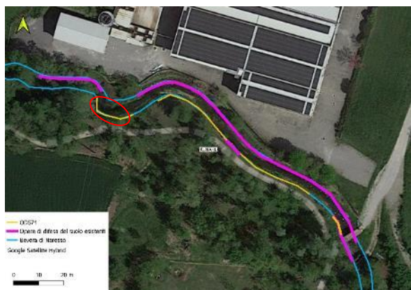
Figura 1-15 Criticità D2: Marcata erosione spondale in sinistra idrografica a valle del tratto protetto da scogliera
