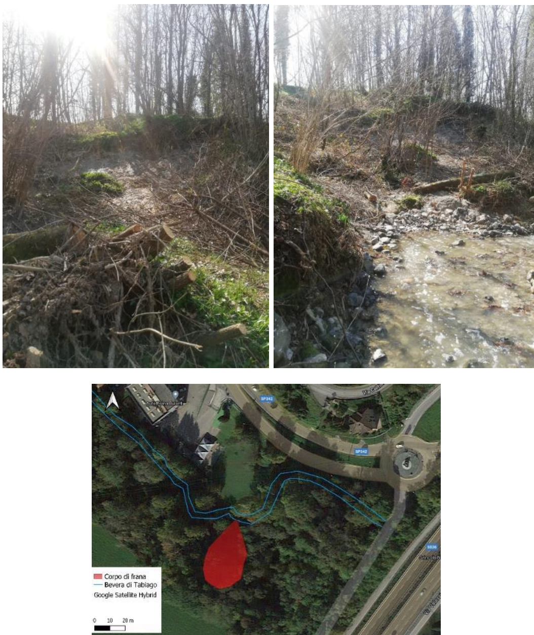
Figura 1-18 Criticità E1: Vista del corpo di frana dall'alveo. Parte del materiale si è depositato lungo la sponda sinistra della Bevera.
