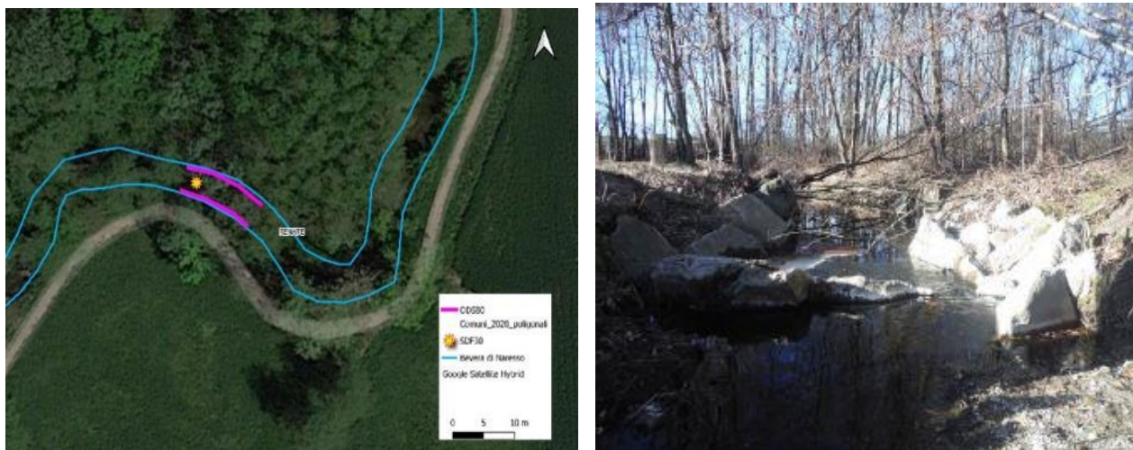
Figura 1-16 Criticità D3: Presenza significativa di vegetazione riversa in alveo e di una scogliera in parte collassata in alveo
